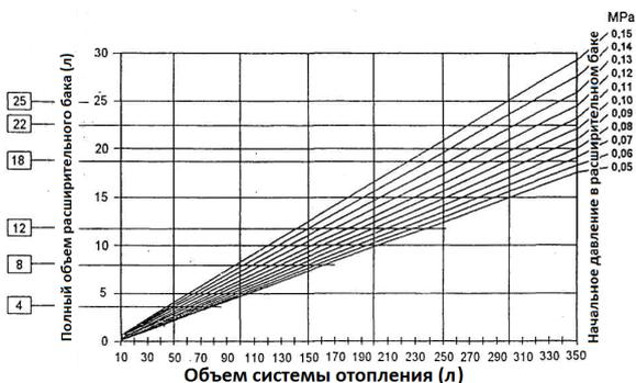
**Пример:** по расчёту система требует установки расширительного бака ёмкостью 15 литров, котёл оборудован расширительным баком 8 л, т.е.  $15 - 8 = 7$  л. Следовательно, необходимо установить дополнительно бак объёмом 7 л. По номограмме выбираем ближайший больший стандартный расширительный бак объёмом 8 литров.
